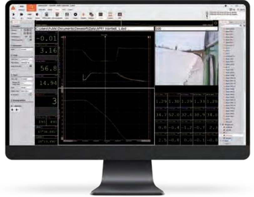
DewesoftX DAQ yazılımı tarafından kaydedilen İsveç'teki gerçek bir fren testinden ekran görüntüsü.
